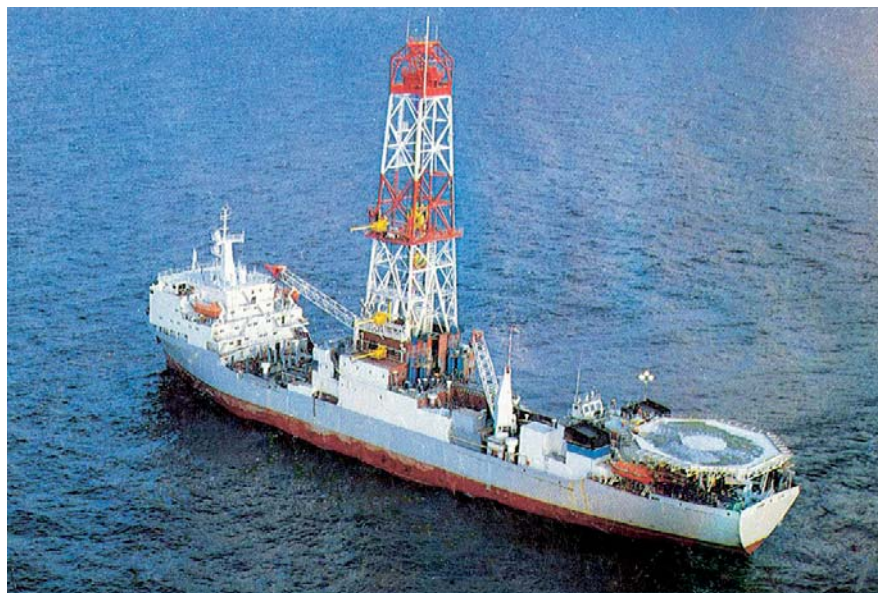
Буровое судно «Валентин Шашин» с водолажным комплексом для спусков на глубины до 300 м
