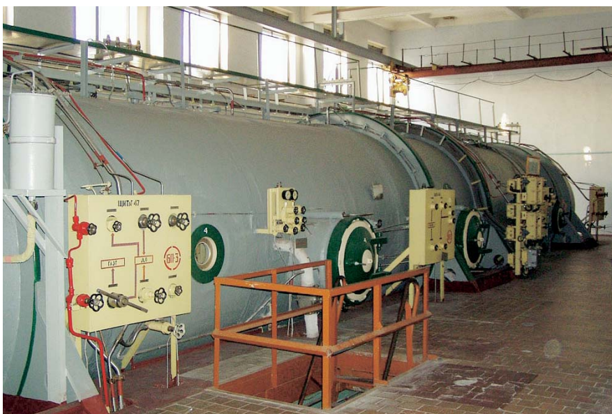
Барокомплекс ГПК-50 на давление до 500 м вод.ст. 40-го ГосНИИ МО
