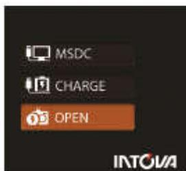
Для одновременной зарядки и доступа к настройкам камеры выберите пункт ОТКРЫТЬ (OPEN). После выбора этого режима на LCD экране отобразится живое изображение.
