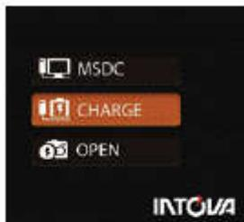
После подключения камера включится, используйте кнопки ВВЕРХ / ВНИЗ для выбора ЗАРЯДКА (CHARGE). Световой индикатор загорится красным и будет светиться на протяжении всего процесса зарядки. Когда аккумулятор будет полностью заряжен, световой индикатор погаснет.
