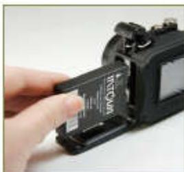
Установите Литий-ионную аккумуляторную батарею в батарейный отсек контактами в сторону лицевой части камеры. Поверните фиксатор батареи на 90°.
