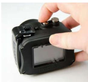
**Включение:** Нажмите и удерживайте кнопку включения в течение двух секунд. Экран загорится, и камера перейдет в основной режим.
