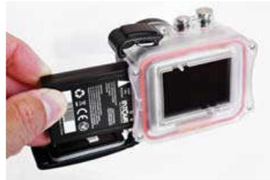
Установите аккумуляторную батарею в батарейный отсек контактами в сторону лицевой части камеры. Поверните фиксатор батареи на 90°
