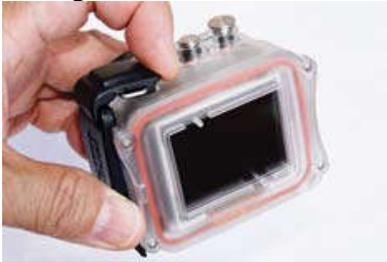
Потяните защелку вверх и вбок, чтобы открыть крышку. Снимите зацеп замка и откройте крышку бокса.
