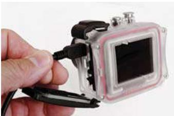
Заряжайте камеру, подключив ее при помощи USB кабеля (в комплекте) к соответствующему порту на вашем компьютере или другому USB-источнику питания (напряжение и ток должны быть 5V, 1A). Время зарядки для разряженной батареи составляет около 6 часов. При зарядке от компьютера, убедитесь, что компьютер подключен к источнику питания. Если красный индикатор зарядки не включается, попробуйте использовать другой USB порт.
