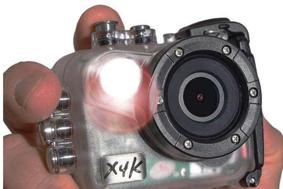
Камера оснащена встроенным источником света яркостью приблизительно 150 люмен. На поверхности эта подсветка (а также вспышка) эффективна на расстоянии до 3 м. Под водой, в условиях хорошей видимости свет можно использовать на расстоянии до 1,5 м. для экономии заряда аккумулятора используйте свет только при необходимости.
