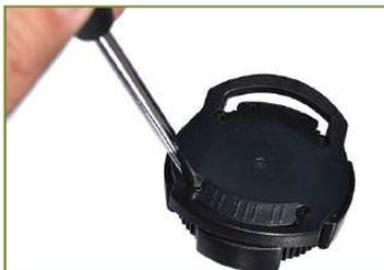
1. Снимите ремешок и при помощи отвертки удалите 4 винта на крышке
